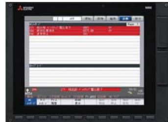
ドライブユニットのバッテリ電圧が低下した際には、①S52/Z73 サーボ警告 009F (軸名称) もしくは②S04/Z71 サーボ異常 0025 (軸名称) のアラームが発生します。
